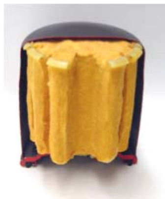
図表3 成形体オイルフィルタの断面写真
