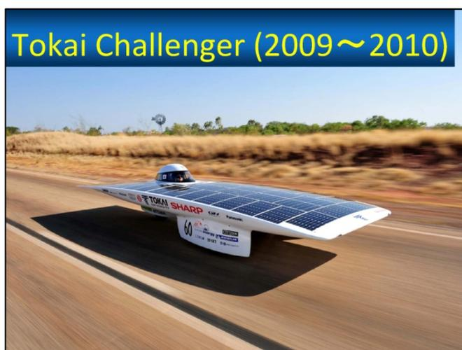
小さくしています。また、流線形の形状にすることで空気抵抗を減らして、さらに炭素繊維を使って軽くすることで、超省エネの電気自動車にしています。
