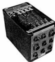
LSI化されたCPUを 装着した制御ユニット
